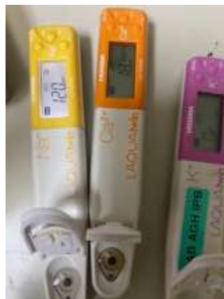
Analisis tanah dengan menggunakan ion meter
